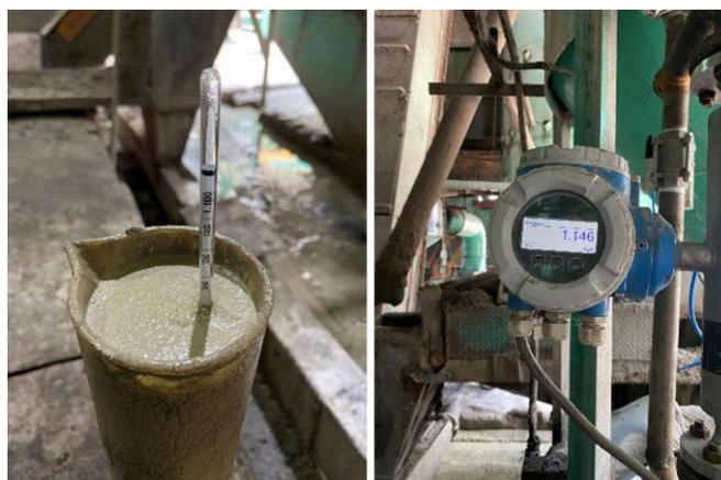
Gambar 3.3 Pengukuran Nilai Densitas Menggunakan *Hydrometer* (Kiri) dan *Flow Meter* (Kanan)
