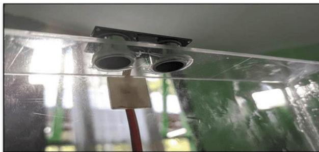
Gambar 13 Pengujian sensor ultrasonik
