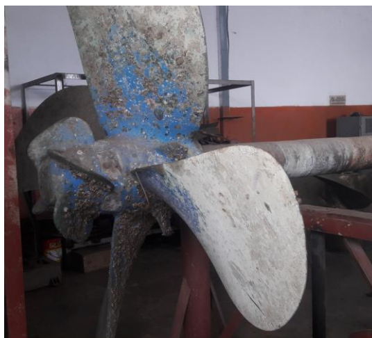
Gambar 2. Propeller Boss cap fin pada fix propeller
