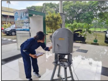
Gambar 26 Pengujian remote control terhadap gerak senjata
